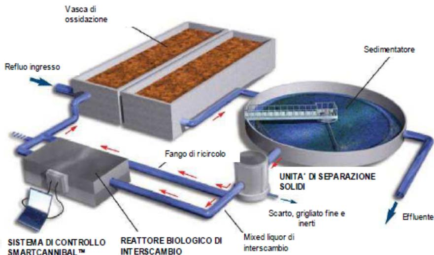
La sezione di separazione dei solidi ha la funzione di evitare l'accumulo del grigliato fine e di solidi inerti all'interno dell'impianto. Essa è installata sulla linea di ricircolo dei fanghi e consente di produrre un residuo con un contenuto di sostanza secca del 40 - 50 %. Le principali apparecchiature costituenti la sezione separazione solidi sono la griglia a tamburo, con sistema di lavaggio integrato, gli idro-cycloni, il classificatore di inerti e il compattatore del grigliato.
