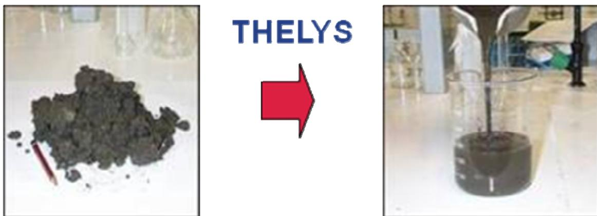
La figura sopra mostra chiaramente la differenza di viscosità tra un fango disidratato al 15% prima e dopo trattamento di idrolisi termica.
