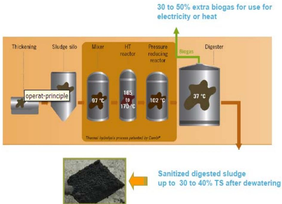
*Performances* - Con oltre 12 anni di continuo sviluppo con gli impianti attualmente realizzati che dispongono di un sistema di pompaggio migliorato nelle prestazioni e nei materiali, un semplice ed efficiente impianto di controllo degli odori e l'installazione di una linea di ricircolo dal digestore allo scambiatore di calore che riduce la viscosità, incrementa il pH e mantiene costante il flusso oltre
